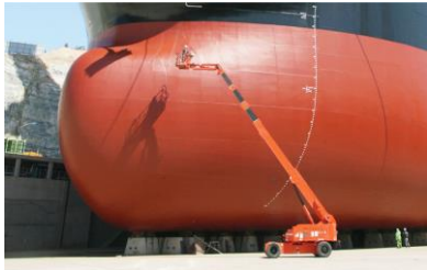
[사진2. 단순 고소 작업(도장 검사)]
