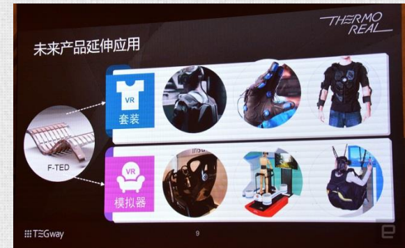
△ 급속 가열, 냉각이 가능한 슬림하고 유연한 열전기 소자를 통해서 섭씨 4도~40도까지 조절 가능. 동일한 표면의 서로 다른 구역에서 열과 냉기를 동시에 생성하므로써 피부의 조임을 시뮬레이션하여 고통을 유발.
