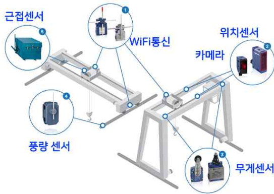
< 각종 센서를 장착한 Gantry Crane >
